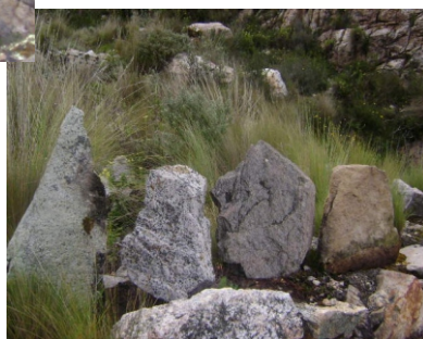
Tipos de piedras empleadas en la construcción: de izquierda a derecha, la primera piedra Aleymosca, segunda Azucrada, tercera piedra azulina azucarada, último piedra Caliza.
